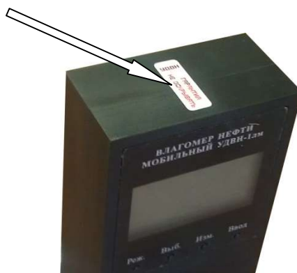
Рисунок 2 - Место пломбирования влагомеров нефти мобильных УДВН-1лм
