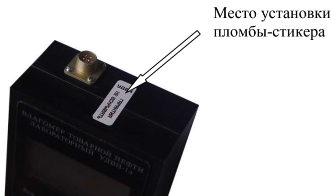
Рисунок 2 - Место пломбирования влагомеров нефти лабораторных УДВН-1л
